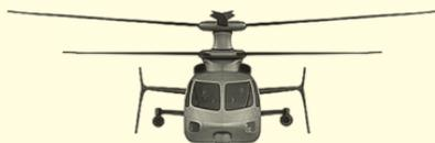
Sikorsky S-97 — это разведывательный вертолет американской компании Sikorsky Aircraft, построенный по соосной схеме с толкающим винтом в хвостовой части. Разработан на базе экспериментального вертолета X2 той же фирмы. Первый полет S-97 запланирован на 2015 год.
