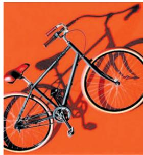
лезная цепь заменена на приводной ремень, не требующий смазки и обеспечивающий более плавный ход. Специальные «антипроколные» шины, изготовленные по технологии gumflat, позволят сохранить ход даже при их повреждении.
